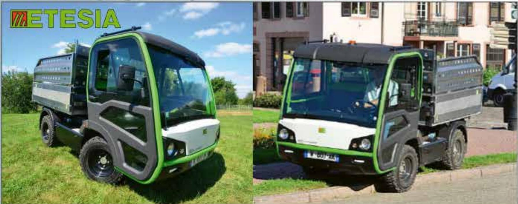
ET Lander: das neue Elektro Multifunktionsfahrzeug von ETESIA mit hydraulisch kippbarer Ladebrücke (auf 3 Seiten)
